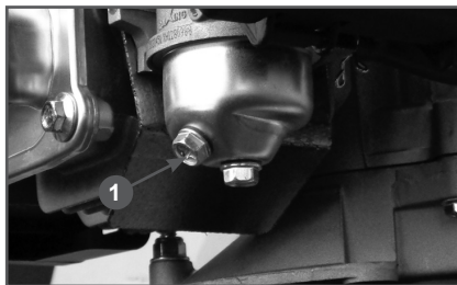
Рис. 22 Слив топлива с поплавковой камеры карбюратора
