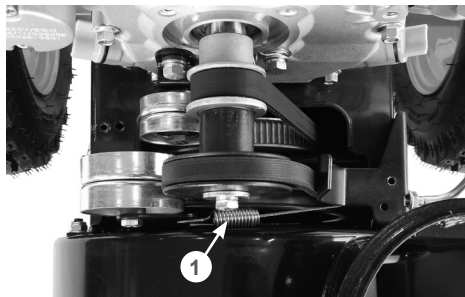
Рис. 9 Регулировка троса включения шнеков
