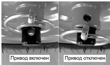
Рис. 35 Перестановка шплинта на левом колесе
