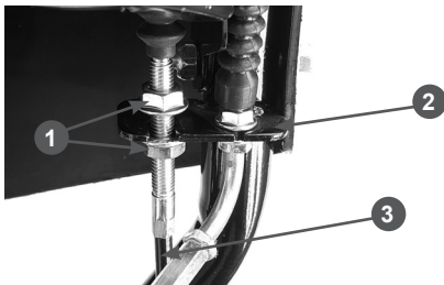
Рис. 11 Крепление оболочки троса включения хода
