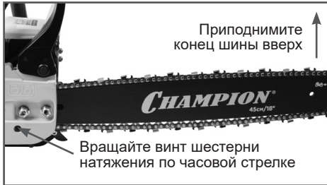
Рис. 5 Регулировка натяжения цепи
