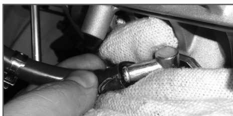
Рис. 10 Удаление воздуха из топливного шланга
