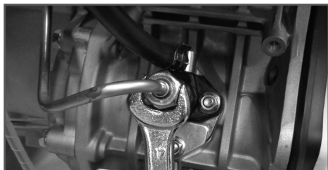
Рис. 12 Удаление воздуха из топливного насоса
