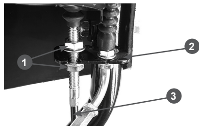
Рис. 11 Крепление оболочки троса включения хода
