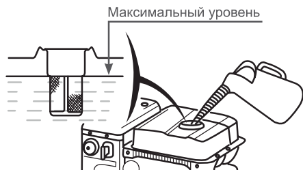
Рис. 31 Максимальный уровень топлива в топливном баке
