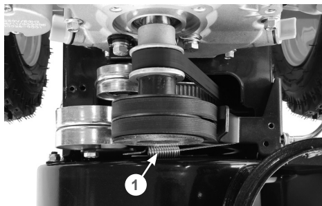
Рис. 9 Регулировка троса включения шнеков
