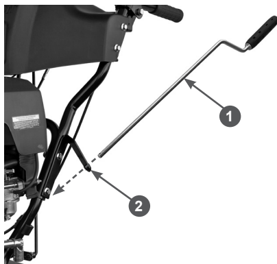
Рис. 26 Установка рычага управления поворотом жёлоба
