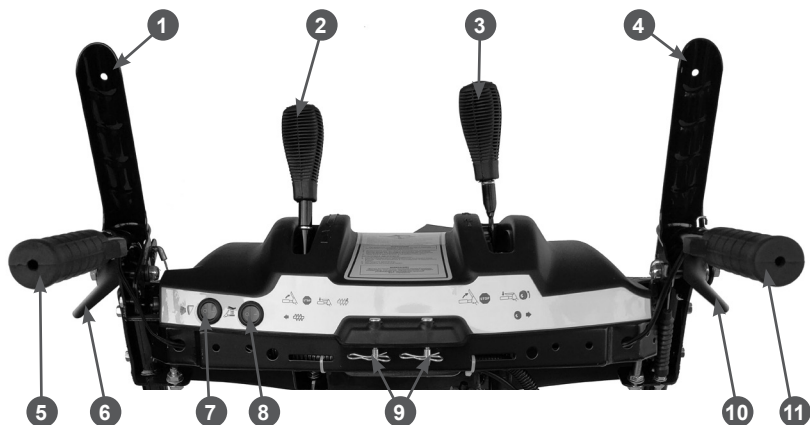
Рис. 3 Панель управления (вид со стороны оператора)
