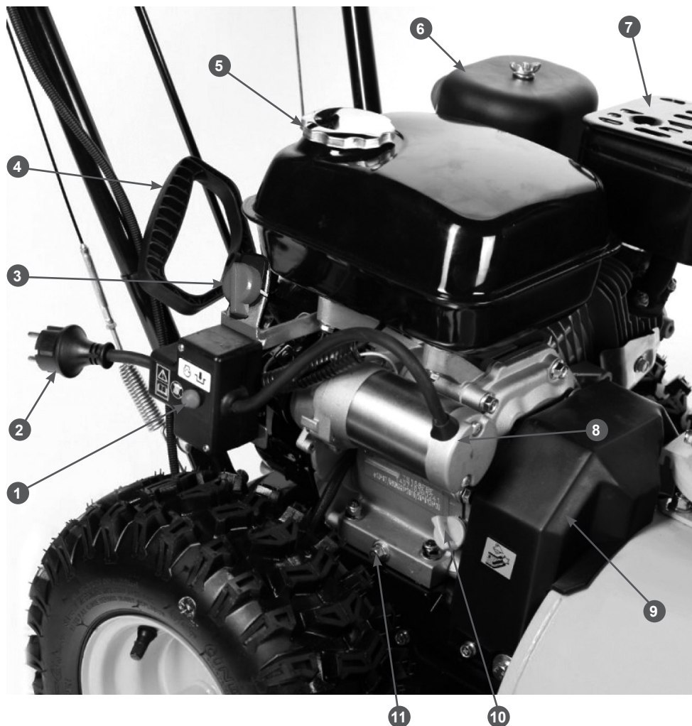
Рис. 2 Основные узлы и органы управления
