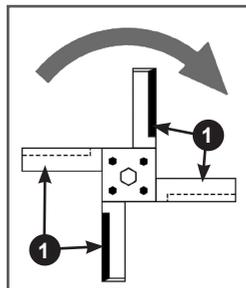
**Рис. 13 Расположение ножей на фланцах оси фрезы**
