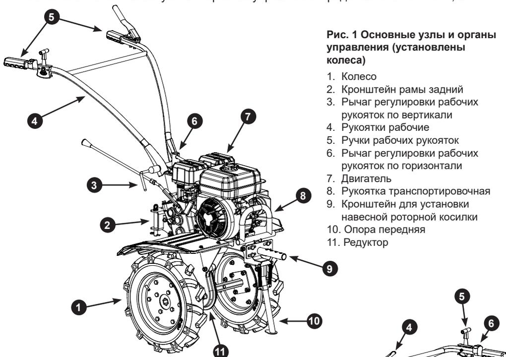
**Рис. 1 Основные узлы и органы управления (установлены колеса)**
