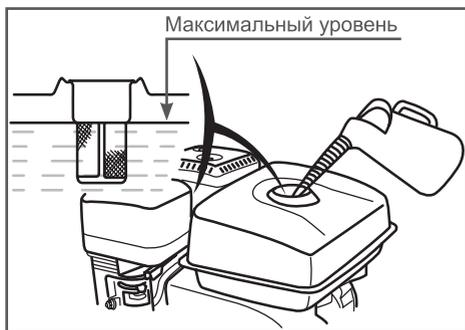
Рис. 24 Максимальный уровень топлива в топливном баке
