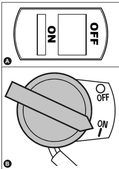
Рис. 30. Выключатели зажигания
