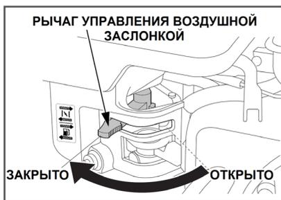
Рис. 27 Рычаг управления воздушной заслонкой
