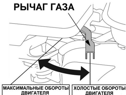
Рис. 9. Положения рычага газа
