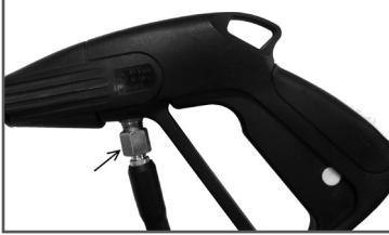
Рис. 4 Подсоединение шланга высокого давления к пистолету HP6160
