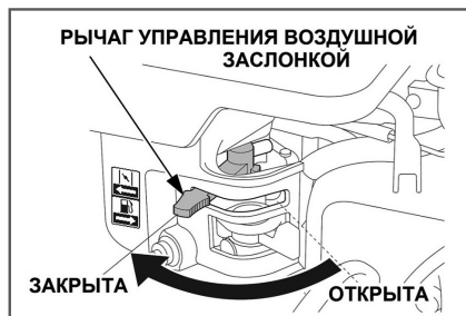
Рис. 10 Рычаг управления воздушной заслонкой
