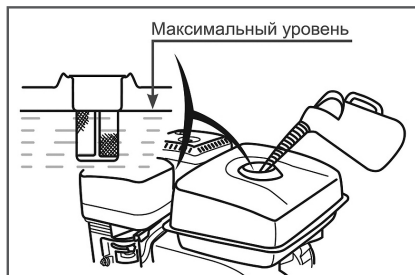
Рис. 6 Максимальный уровень топлива в топливном баке
