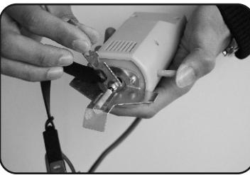
3. Ослабьте болт на верхней пластине при помощи отвертки. Подберите подходящий размер заточного камня, совместив линии на металлической пластине с соответствующей линией на пластиковой раме.
