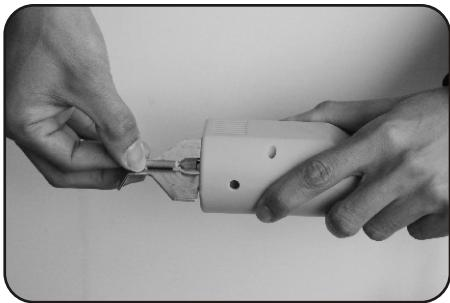
2. Затяните камень в зажимном устройстве, используя гаечные ключи, которые расположены на электрическом кабеле.
