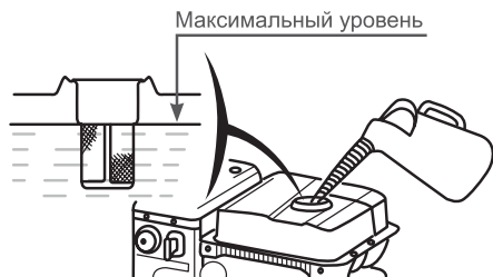
Рис. 31 Максимальный уровень топлива в топливном баке
