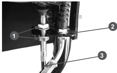
Рис. 11 Крепление оболочки троса включения хода
