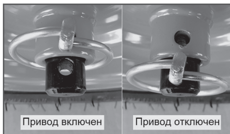
Рис.10 Перестановка шплинта на левом колесе
