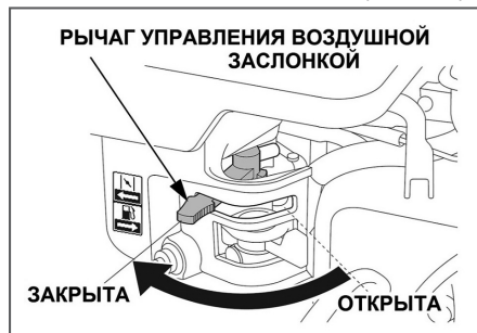
Рис. 10 Рычаг управления воздушной заслонкой
