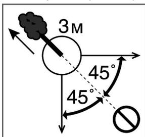
Рис. 14 Расчет пути отхода при валке дерева
