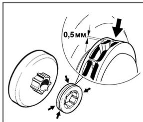
Рис. 29 Максимально допустимая глубина износа зубьев ведущей звездочки
