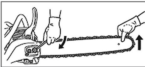
Рис. 4 Затяжка гаек крепления шины
