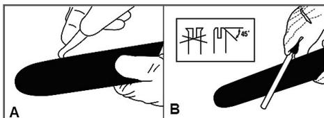
Рис. 28 Обслуживание шины
