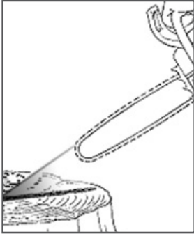
Рис. 9 Проверка смазки шины и цепи
