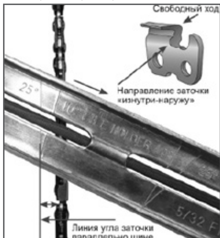
Рис. 18 Определение угла заточки
