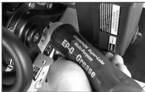
Рис. 23 Добавление смазки в редуктор
