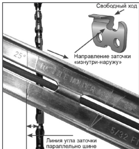
Рис. 28 Определение угла заточки
