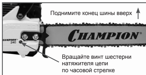
Рис. 5 Регулировка натяжения цепи
