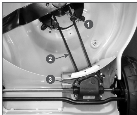
Рис. 29 Проверка состояния ремня привода 1. Шкив вала двигателя 2. Ремень 3. Редуктор
