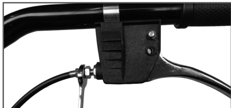
Рис. 10 Установка регулировочной муфты троса газа
