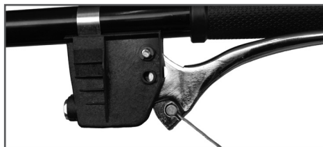
Рис. 9 Установка наконечника троса газа
