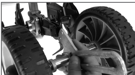
Рис. 6 Установка кронштейна колес
