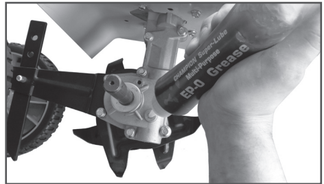
Рис. 24 Добавление смазки в корпус редуктора
