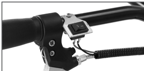
Рис. 13 Подключение проводов к выключателю зажигания
