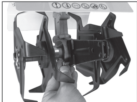
Рис. 5 Установка кронштейна сошника
