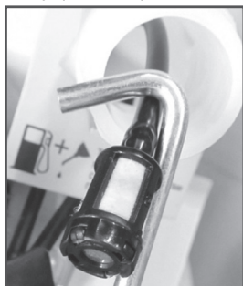
Рис. 21 Извлечение топливного фильтра
