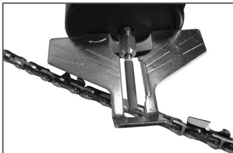
Рис. 6 Исходное положение заточного камня относительно цепи
