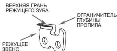
Рис. 4 Конструкция режущего звена
