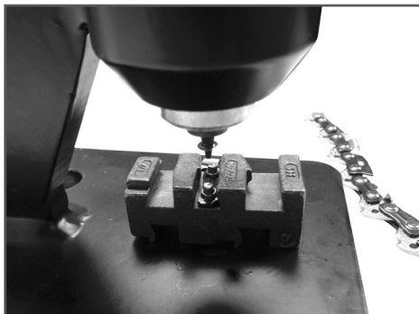
Рис.4 Вид наковальни и пробойника после расклепки звена
