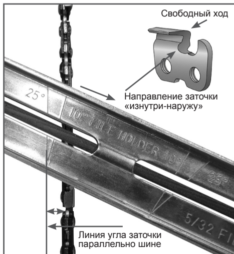
Рис.22 Определение угла заточки
